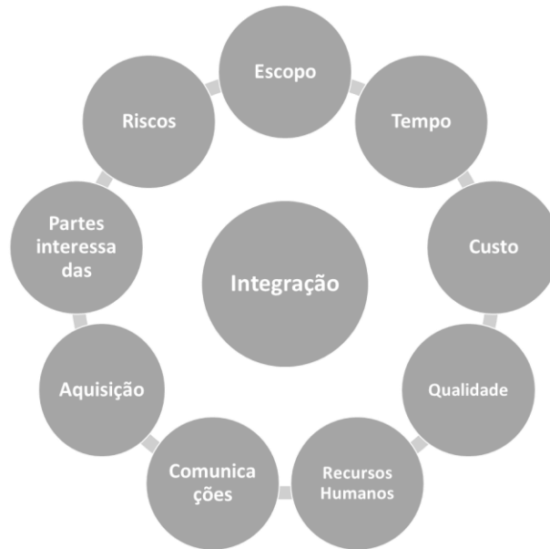
Figura 1 – As Áreas de Conhecimento do Gerenciamento de Projetos de Acordo com o PMBOK 5
