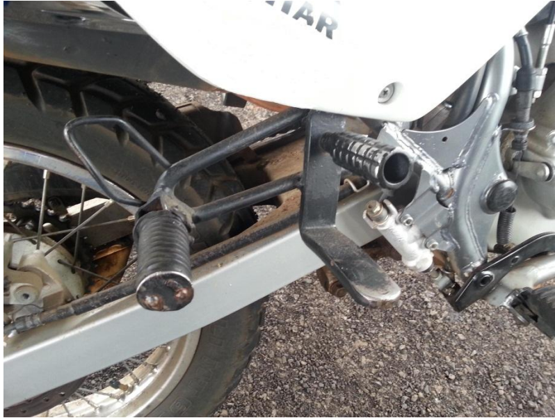
FIGURA 19 – Pedaleira adaptada para o garupa Fonte: Elaborado pelo autor.
