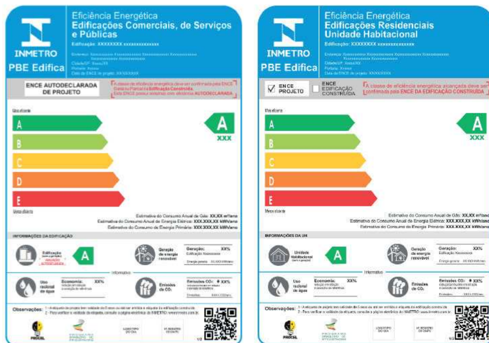
Figura 3: Exemplos de etiquetas de eficiência energética de projeto e de edificação construída a partir das Instruções Normativas do Inmetro (INIs), que já podiam ser emitidas a partir de 2022 para projeto e para edificação construída
