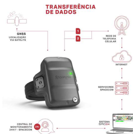
Figura 1 - Esquema de funcionamento da tornozeleira eletrônica fabricada pela empresa Spacecom .
