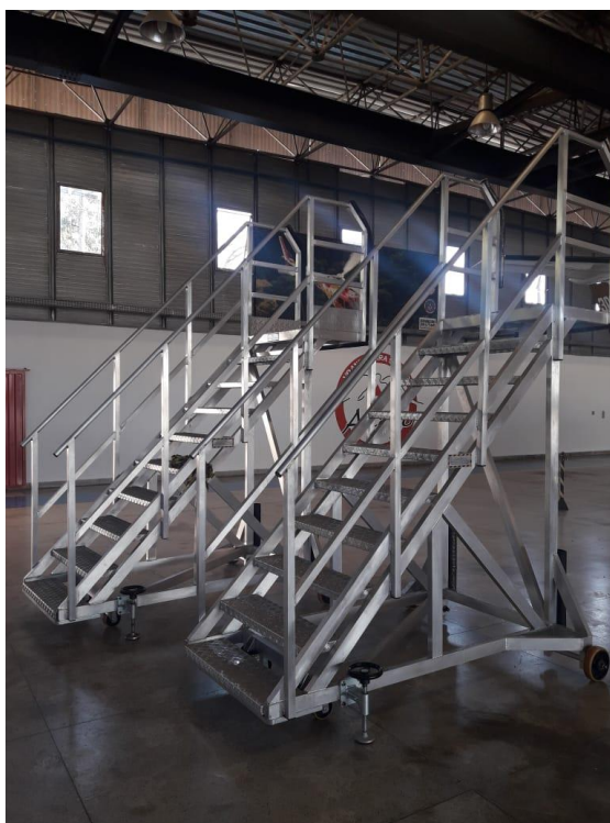
Figura 18 - Escada para executar manutenção nas aeronaves
