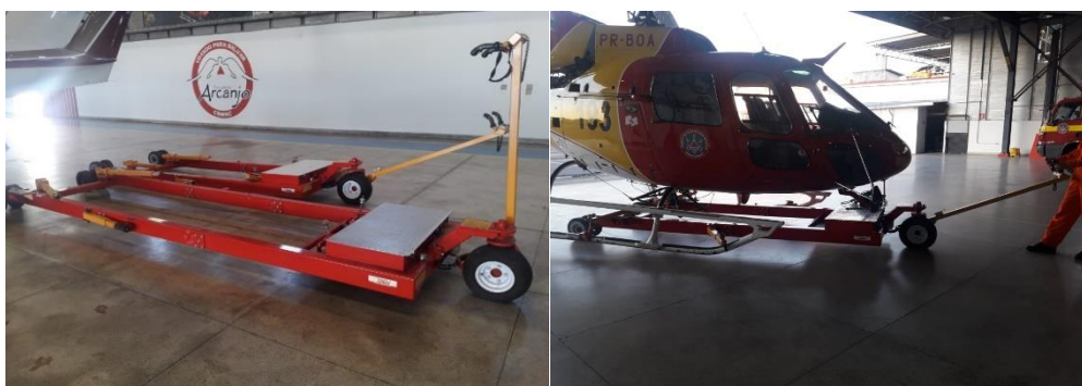
Figura 16 - Carrinho de transporte de aeronave
