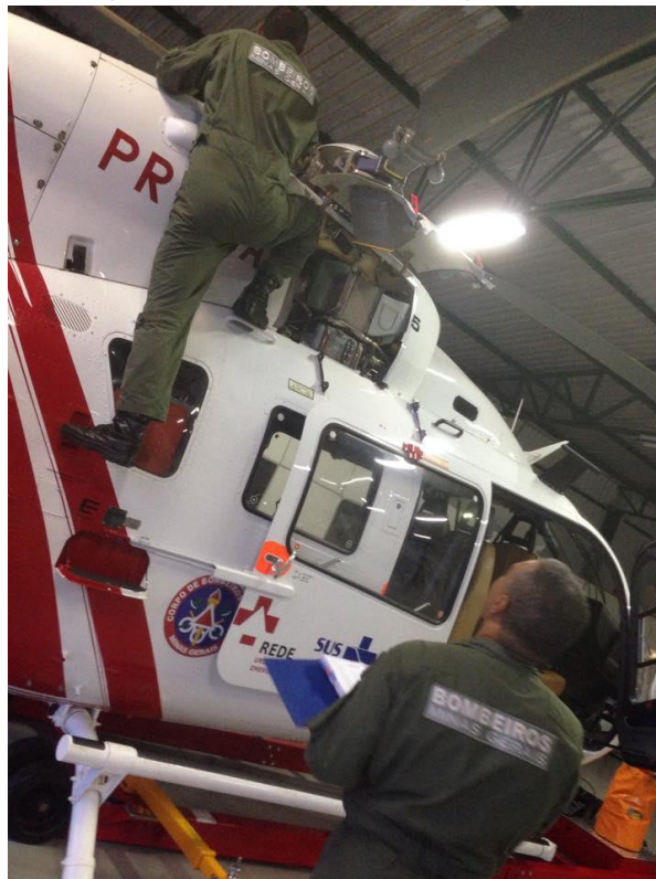
Figura 10 - Inspeção diária de pré-voo realizada sob supervisão do mecânico mais antigo
