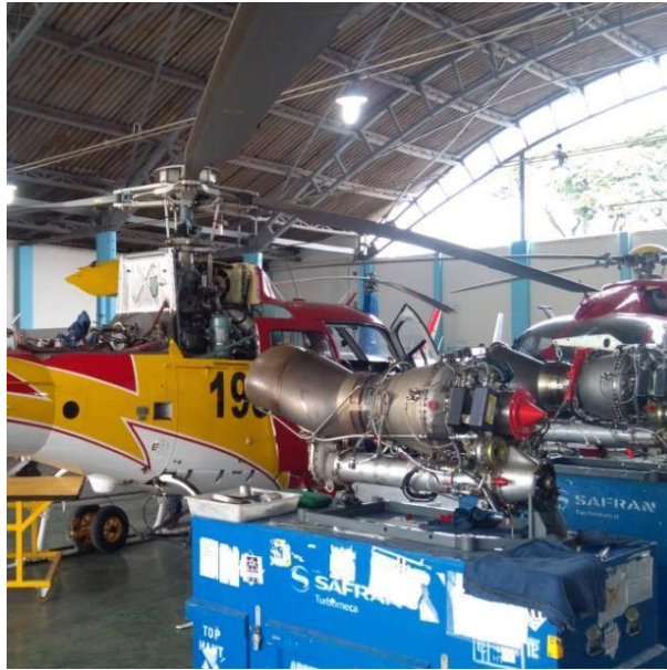
Figura 12 - Troca de motor na aeronave prefixo PR-BOA do CBMMG
