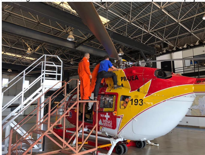
Figura 9 - Mecânico orgânico fiscalizando e apoiando realização de inspeção pela contratada
