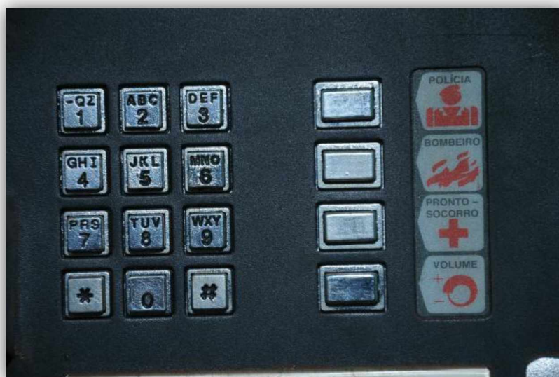
Figura 5 - Layout de um TUP (orelhão) moderno.
