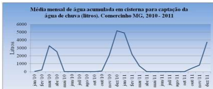
Gráfico 1 - Simulação da média mensal de água armazenada em cisternas para captação da água de chuva para consumo humano - consumo de 100 litros diários durante todo o ano. Comercinho, Minas Gerais, 2010-2011.
