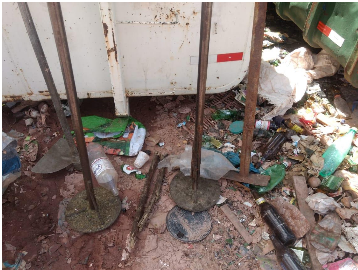
Figura 7.18 – Equipamentos para trituração de vidro utilizados pelos catadores da COOPEMAR
