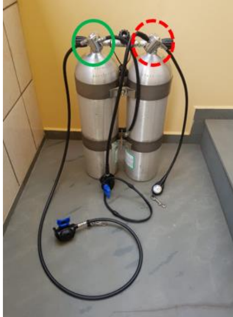
Figura 25 – Reguladores primário (verde contínuo) e secundário (vermelho pontilhado)
