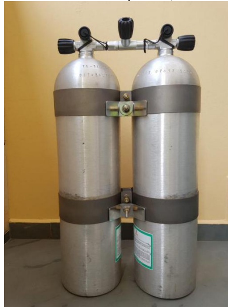
Figura 22 – Cilindro duplo de S80 com torneiras tipo DIN, com cintas de inox e isolador manifold
